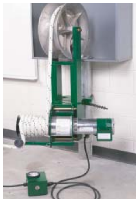
Поднимающаяся тяга с устройством Ultra Tugger и трубным переходным роликом, закрепленные на трубопроводе.
